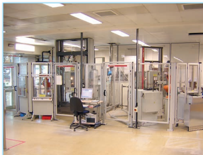
Fig. 7 Fully automated set-up for tensile/compression testing CFK materials at Hexcel Duxford, UK Impianto completamente automatizzato per le prove di trazione/compressione su materiali CFK presso Hexcel, Duxford, UK
