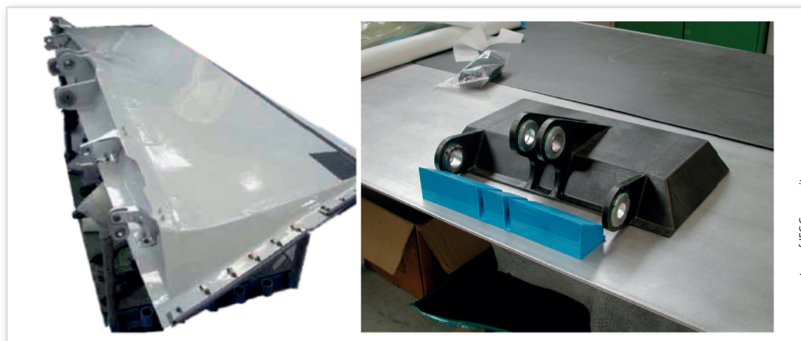
Fig. 1 A composite centre hinge fitting replaced a forged aluminium component on the Airbus A340-600 commercial jet Una cerniera in composito al posto dell'alluminio su Airbus A340-600
