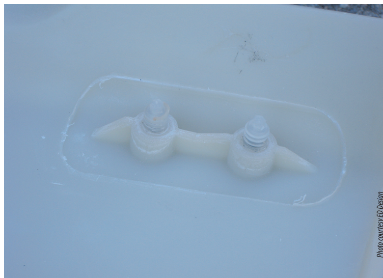
Fig. 1 B side of 1800 prototype parts can be molded exactly as per original CAD file Il lato B di una parte del prototipo 1800 può essere stampata esattamente come da file originale CAD
