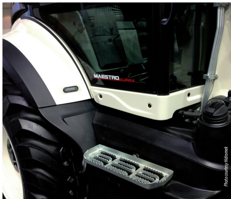
Fig. 5 Hidromek's Maestro show model at Bauma was featuring its serial pDCPD fenders and cabin fittings Technica I Data Sheet Telene 1810 (source: Telene SAS) / Presentazione del modello Hidromek a Bauma con parafranghi di serie pDCPD e accessori cabina. Scheda tecnica di Telene 1810
