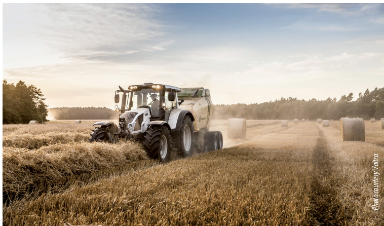
Fig. 2 Prototype hoods from the new Valtra N4 series were produced using Telene 1810 I cofani del prototipo della nuova serie Valtra N4 sono stati prodotti con Telene 1810
