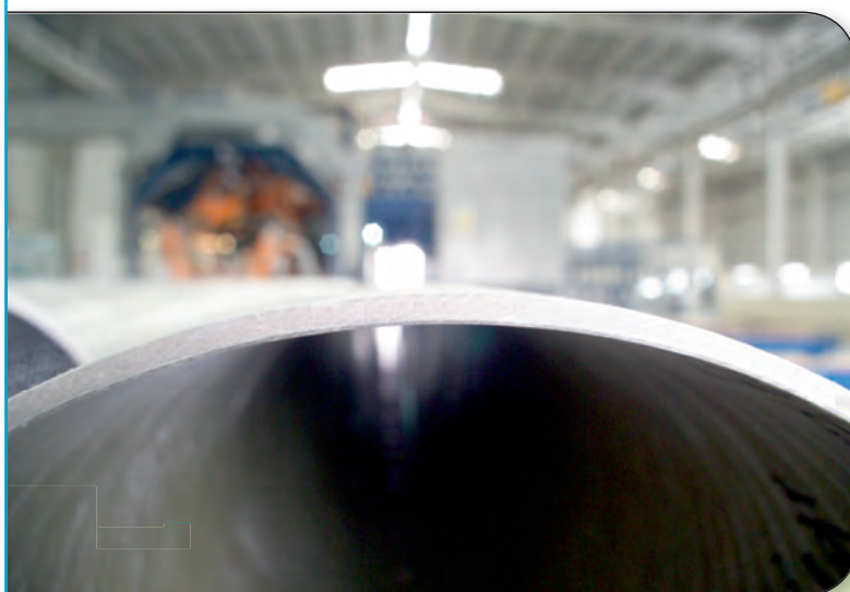
Fig. 4 - Condotte in GRP prodotte con il sistema SPS GRP pipe produced with SPS
