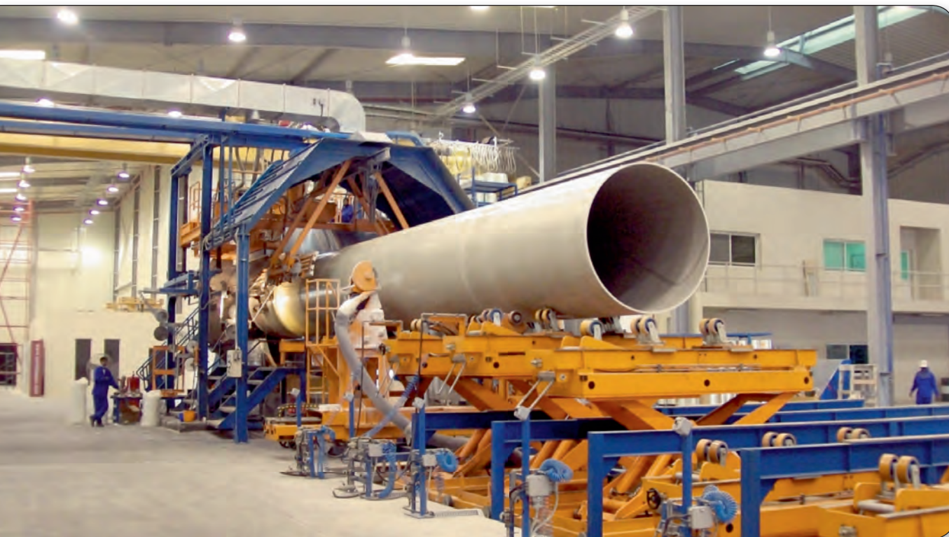
Fig. 1 - Fase di lavorazione di una condotta con un macchinario CFW A CFW machine with a pipe being produced
