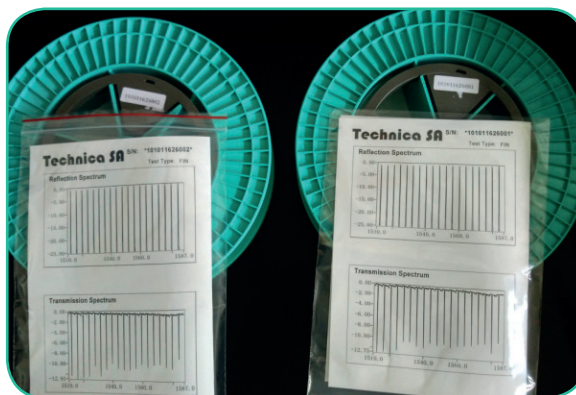
Fig. 1 - Bobine T 130 GFRP FBG prima e dopo l'applicazione
