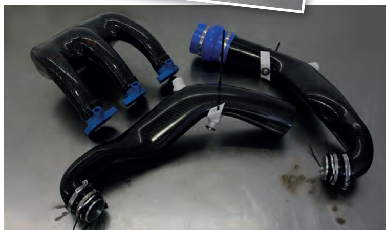
Array of complex composite ducts made from FDM soluble cores Serie di condotti complessi in carbonio costruiti con stampi interni solubili
