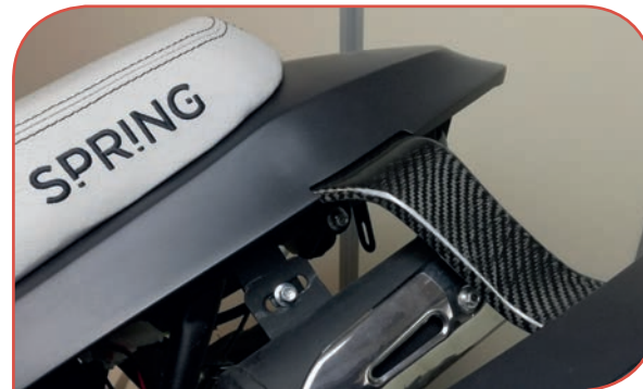
Fig. 2 - Supporto del parafango finito e montato sul quad
