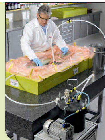
Fig. 2 - Il processo ad infusione di resina consente di ottenere un'elevata qualità e una ridotta variabilità dello spessore delle parti, nonché elevate proprietà meccaniche The resin infusion process facilitates a high part quality with low part thickness variance as well as high mechanical properties
