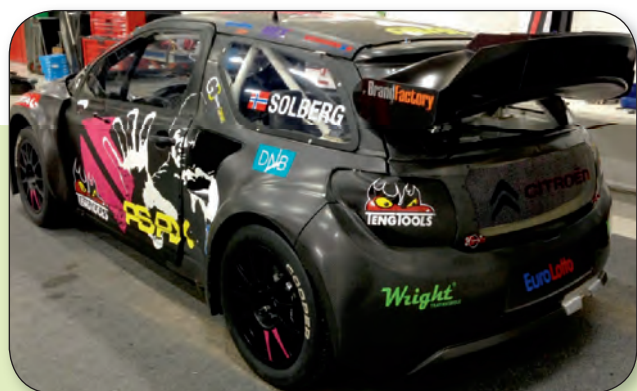
Fig. 1 - La Citroën DS3 Rallycross Supercar modificata di Petter Solberg. In totale, gli undici nuovi pannelli del telaio in composito leggero carbon-Kevlar forniti dalla Galway Carbon hanno consentito di ridurre di oltre 56 kg il peso originale di 1200 kg della DS3 di Petter Solberg Petter Solberg's finished Citroën DS3 rallycross supercar. Overall, the eleven new lightweight carbon-Kevlar composite body parts supplied by Galway Carbon reduced the original 1200kg weight of Petter Solberg's Citroën DS3's by over 56kg
