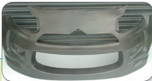
Fig. 3 - Paraurti anteriore sostitutivo in lega carbon-Kevlar. Il più ampio pannello in carbon-Kevlar® prodotto è stato il paraurti anteriore della superficie di 1,75 m² che la Galway Carbon ha modificato riducendone il peso a soli 2,17 kg Replacement Carbon-Kevlar composite front bumper. The largest carbon-Kevlar® composite body panel fabricated was the 1.75 sq. m front bumper, which was redesign down to a weight of only 2.17kg
