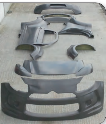
Fig. 2 - Gli 11 pannelli sostitutivi in lega carbon-Kevlar. Ciascuno degli undici pannelli della Citroën DS3 Rallycross Supercar di Solberg è stato costruito tramite infusione sotto vuoto utilizzando il sistema ad alte prestazioni Crestapol® 1250LV Scott Bader una resina di uretano a base di acrilato rinforzata con tessuto Kevlar e fibra di carbonio The 11 replacement Carbon-Kevlar composite body panels. Each of the eleven new composite body panels for Solberg's Citroën DS3 Rallycross super-car was vacuum infused using Crestapol® 1250LV urethane acrylate type acrylic resin reinforced with carbon fibre and Kevlar fabrics
