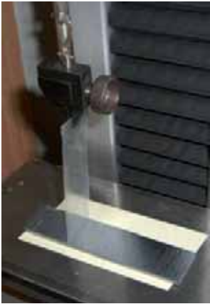
Fig. 2 Test setup di un peel a 90° secondo ISO 8510-1:1990 [3] Test setup of a 90° peel test according to ISO 8510-1:1990 [3]
