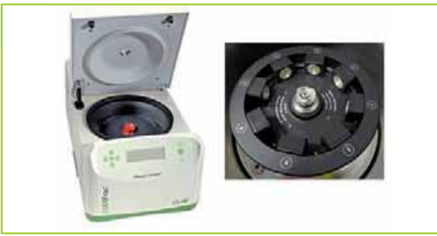
Fig. 5 Analizzatore di Adesione LUMiFrac® (a sinistra) ed il rotore con gli 8 sensori di rottura installati (a destra) Adhesion Analyser LUMiFrac® (left) and rotor carrying the 8 failure detection modules for the test assemblies (right)
