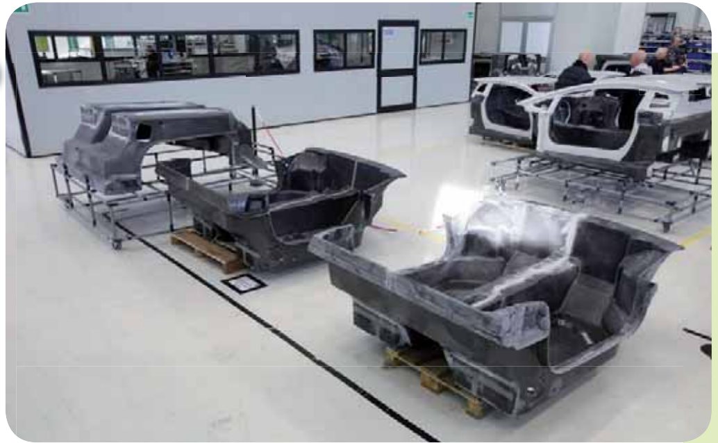
Fig.1 Recentemente, Huntsman ha preso parte attivamente alla realizzazione di vari progetti molto innovativi e ha lanciato la resina Araldite® per la produzione del primo telaio in fibra di carbonio di un'automobile Lamborghini, prodotto con l'ausilio della tecnica fuori autoclave
