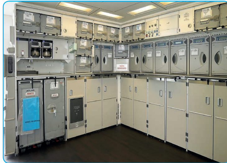
Fig. 1 Bucher sviluppa e produce cambuse per velivoli commerciali. Un modulo totale di questo tipo deve resistere a sollecitazioni almeno nove volte superiori a quelle dell'accelerazione gravitazionale
