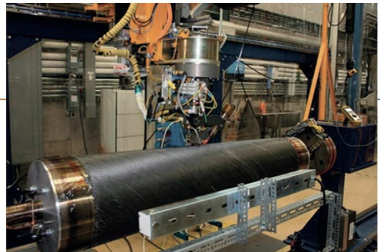
Fig. 4 Automatic Tape Placement (ATP) process Processo di deposizione automatica delle fibre (ATP)
