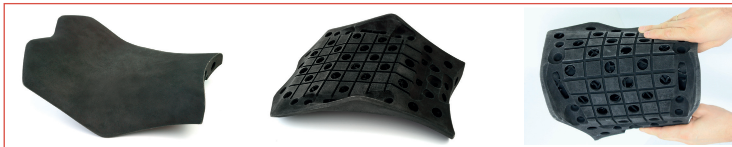
Fig. 4-5-6 - Prototipo funzionale della sella in stampa 3D e Windform® RL (parte morbida). Parte superiore e retro. Da notare elasticità e flessibilità simili alla gomma, struttura interna a nido d'ape. Credit foto 4 e 5: Gianluca Muratori
