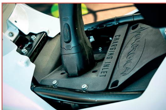
Fig. 3 - Sistema di ricarica di Energica EGO. Credits Royce Rumsey
