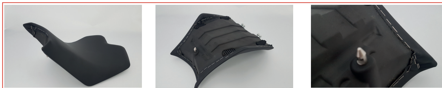
Fig. 7-8-9 - Prototipo funzionale della sella Energica EGO rivestito. Dettaglio del fissaggio con punti metallici
