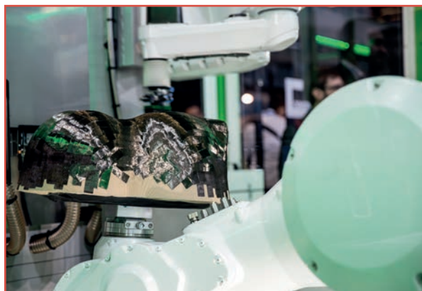
Fig. 1 - Preformato di un tappo a pressione nel sistema di produzione SAMBA Pro
