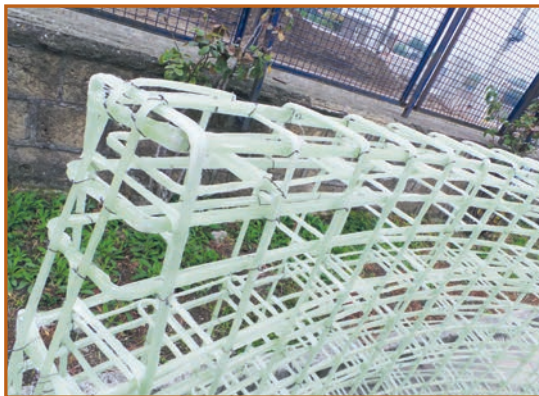
Fig. 4a/4b Dettagli del rinforzo in GFRP per conci realizzato da ATP
