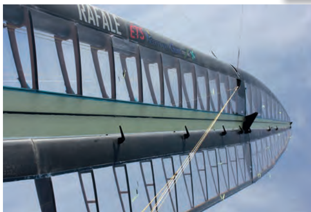
Close-up of the 300 sq ft carbon fiber wing sail Particolare della vela rigida in fibra di carbonio di 300 piedi quadrati
