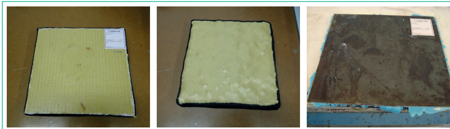
Fig. 1 Campione 2, strato posteriore in composito (a) e strato anteriore in ceramica con due strati in fibra di aramide (b), campione 5 unito con adesivo epossidico (c)
