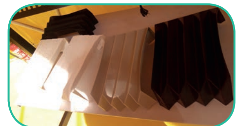
Fig. 4 - Prototipi realizzati con diversi materiali termoplastici del progetto simile a un modello origami dei moduli abitativi
