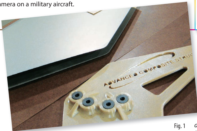
Fig. 2 This FDM layup tool produced the aircraft camera fairings Lo strumento per FDM ha prodotto i sostegni per telecamera
