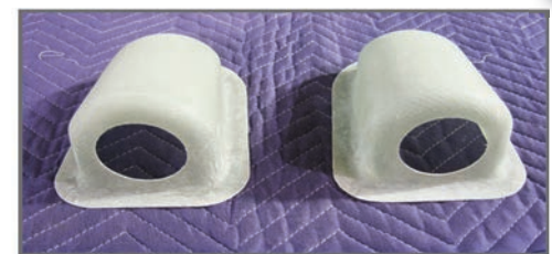
Fig. 2 This FDM layup tool produced the aircraft camera fairings Lo strumento per FDM ha prodotto i sostegni per telecamera
