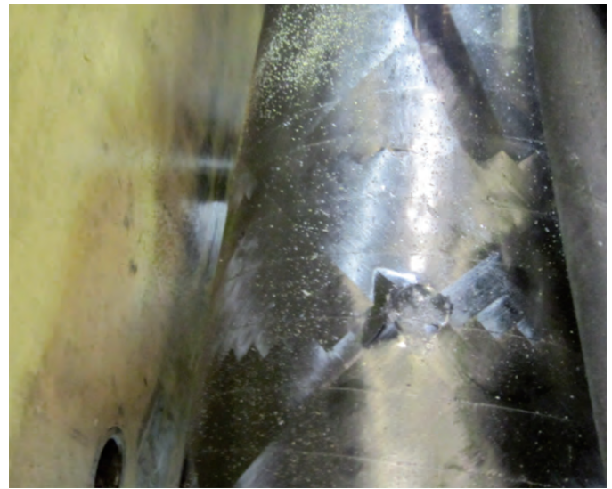
Fig. 6 A detail of the cylinder surface damage caused by the impact test Dettaglio di un danneggiamento della superficie del cilindro indotto dalla prova di impatto
