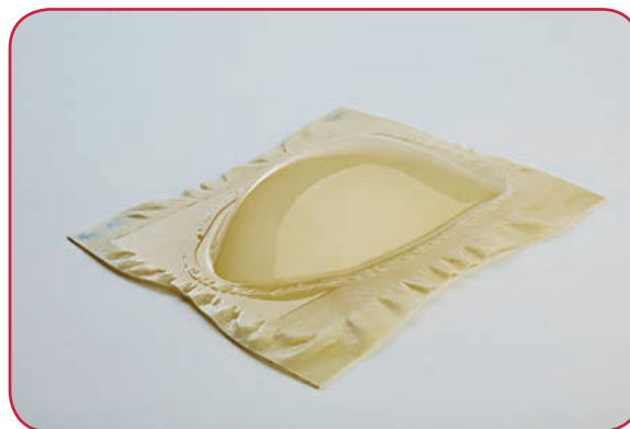
Fig. 6 - Translucent StyLight* with glass fiber woven fabrics StyLight* traslucido con tessuto di vetro
