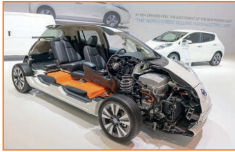
Fig. 11 - Battery housing of an electric car Alloggiamento batteria in un'auto elettrica
