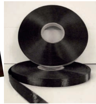
Fig. 4 Tapes cut before weaving Nastri tagliati prima della tessitura
